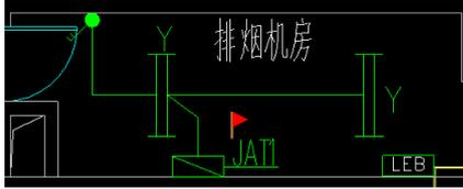
排烟机房中灯具图例中无显示，是否为自带蓄电池应急双管荧光灯，如是明确蓄电时间？另该机房LEB进出线无大样图也无图纸说明，请明确？
